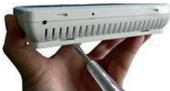
Il cronotermostato è formato da due parti distinte (staffa di installazione e cronotermostato vero e proprio) ed aderenti, tuttavia è necessario separarle per procedere all'installazione: fare leva con un utensile piatto o un grosso cacciavite in una delle due fessure due poste lungo il bordo inferiore per allontanare le due parti, quindi procedere delicatamente a separarle manualmente.
