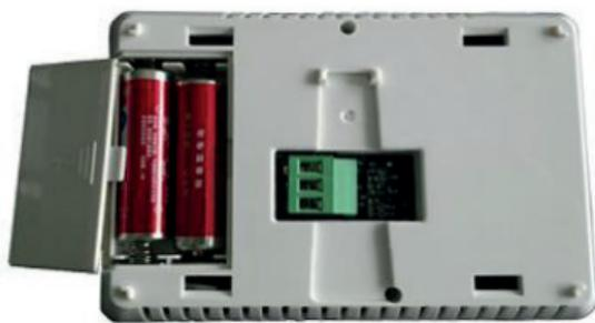
ed eseguiti a regola d'arte i collegamenti elettrici, è possibile applicare il cronotermostato, avendo avuto cura di inserire le batterie (2 alcaline o zinco/carbone formato AA) nell'apposito scomparto rispettando la polarità.
