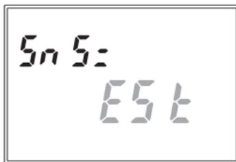
Scegliere tramite i tasti **“▲”** e **“▼”** **“Int”** se si vuole utilizzare la sonda interna oppure **“Ext”** se si vuole utilizzare la sonda esterna e premere **“✓”** per confermare la scelta.
