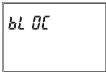
Per sbloccare la tastiera, premere nuovamente i tasti **T1**, **T2** e **T3** per 3 secondi e immettere tramite i tasti **“▲”** e **“▼”** la password di protezione.
