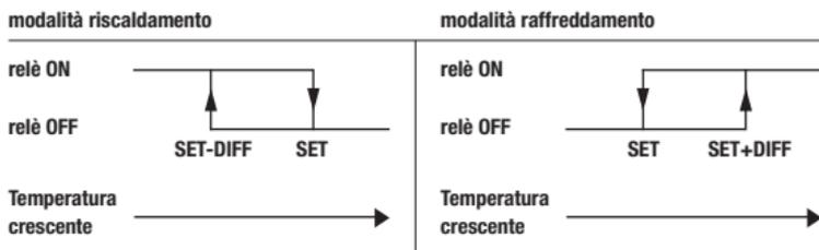
In modalità riscaldamento può essere scelta la regolazione proporzionale che in alcuni tipi di impianti permette di migliorare la regolazione al fine di ottenere una temperatura costante.
