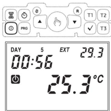
**Nota: Questo comando ha precedenza sul comando da attivatore telefonico, pertanto se si spegne il dispositivo tramite tasto non sarà più possibile accendere/spengere lo strumento con l'attivatore.**
