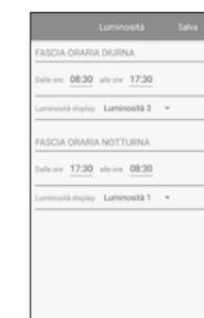
E' possibile definire due fasce orarie (diurna e notturna) e assegnare al display e al led un livello di intensità luminosa diverso per ognuna di esse. Sono disponibili 5 livelli di luminosità, più un livello 0 che corrisponde a display spento (il led invece si accende con intensità minima, ovvero livello 1, perchè non può mai essere completamente spento).
