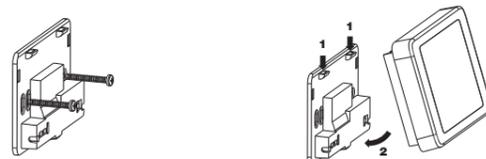
Fissare la base a muro utilizzando le viti in dotazione.
