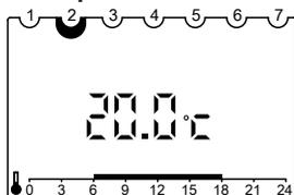
Dalle ore 6.00 alle ore 18.00 avviene il riscaldamento a temperatura ambiente normale e dalle ore 18.00 alle ore 6.00 il riscaldamento a temperatura ambiente ridotta.
