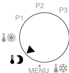
Riscaldamento continuo con temperatura ambiente ridotta (temperatura ridotta).
