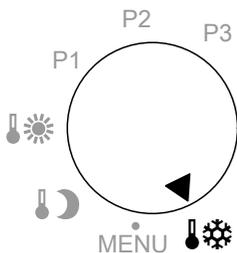
Se la temperatura acqua di caldaia scende al di sotto di quella di protezione antigelo impostata su 5 °C, il bruciatore e la pompa di circolazione vengono inseriti.
