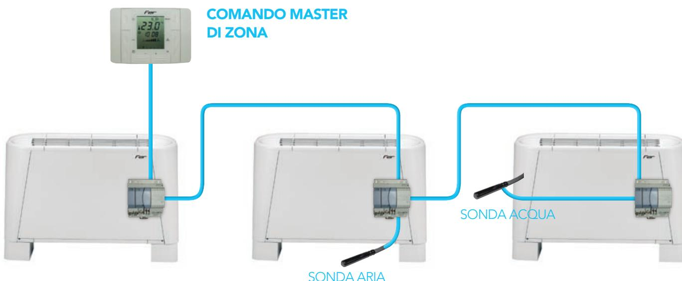
Non sono richieste attività di configurazione indirizzi delle varie unità, tutte funzionano allo stesso modo. La sonda acqua definisce per tutto il gruppo la temperatura per il change over automatico e la funzione prevenzione aria fredda in riscaldamento. Se la sonda acqua è dichiarata non presente, queste funzioni non sono attive.
