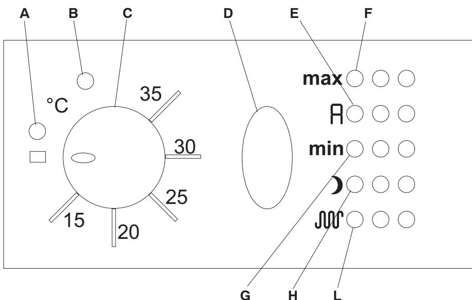
Los 4 leds verdes (Fig. 2, Ref. E, F, G, H) indican el modo de funcionamiento regulado; el 5º representa una función no utilizada.
