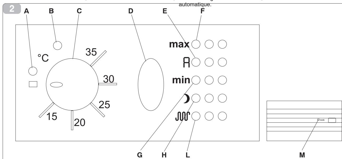
Si después de 10 minutos la solicitud de agua de cada fan coil aún no ha sido satisfecha, el mando a bordo de la máquina se bloquea, el led del mando electrónico de remotización (Fig. 2, Ref. M) comienza a parpadear y se desactiva el contacto de la electroválvula. El desbloqueo es automático, después de 45 minutos o en caso de paso de solicitud de calefacción a solicitud de refrigeración o viceversa, o manual, pulsando el botón MODE (Fig. 2, Ref. D).
