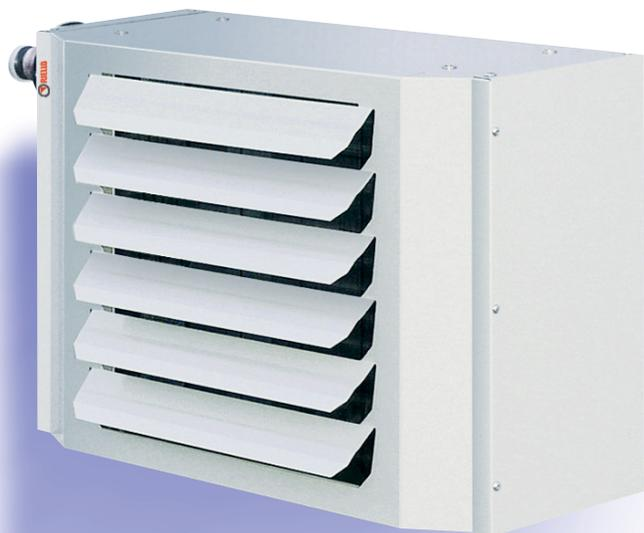
Aerotermi ad acqua per il riscaldamento di ambienti industriali, artigianali, commerciali e sportivi. I terminali sono costituiti da batterie in rame a 2 ranghi, per applicazioni standard, ed a 3 ranghi, ideali per applicazioni con acqua calda a bassa temperatura. Sono disponibili nelle versioni monofase (4 modelli) con potenze termiche rese da 19 kW fino a 43 kW.
