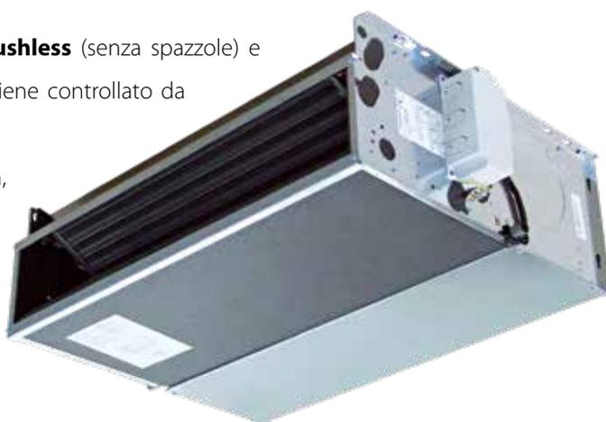
La portata dell'aria può essere variata **in maniera continua** mediante un segnale 1-10 V generato da comandi di regolazione e controllo Sabiana o da sistemi di regolazione indipendenti. Questa possibilità, oltre a migliorare il comfort acustico, consente una più puntuale risposta alla variazione dei carichi termici ed una maggiore stabilità della temperatura desiderata in ambiente.
